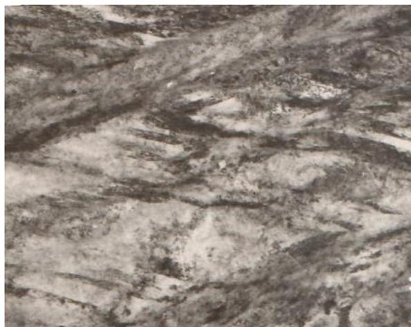
Рисунок 3.27 - Концентрационные области существования  $\alpha$ ,  $\varepsilon$  и  $\gamma$ -фаз (а) и структура (б) стареющих ванадийсодержащих сталей после деформации при  $-196^{\circ}\text{C}$ ,  $\times 38000$
